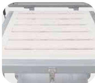
Bundvarme til en ensartet opvarmning af store objekter
